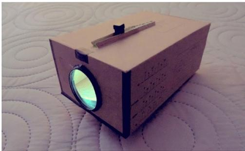
**Realización de la actividad:** Con ayuda de un adulto recortamos el mango de una lupa y hacemos el agujero en la caja, donde colocaremos esa lupa. En la parte superior de la caja hacemos una ranura a modo de hucha donde colocaremos la otra lupa. Grabamos con el móvil un vídeo y colocando el móvil en el interior de la lupa, podremos proyectar el vídeo sobre la superficie deseada.
